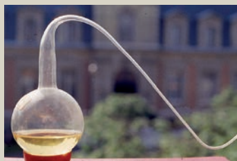
Ballon à col de cygne utilisé dans le cadre des expériences de Louis Pasteur visant à remettre en cause la théorie de la génération spontanée.
